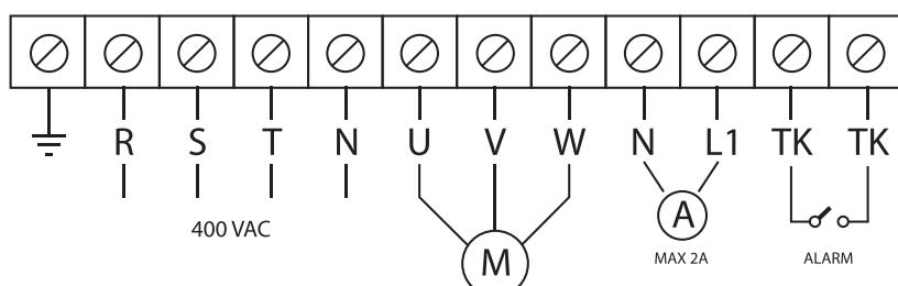
Схема подключения регулятора
